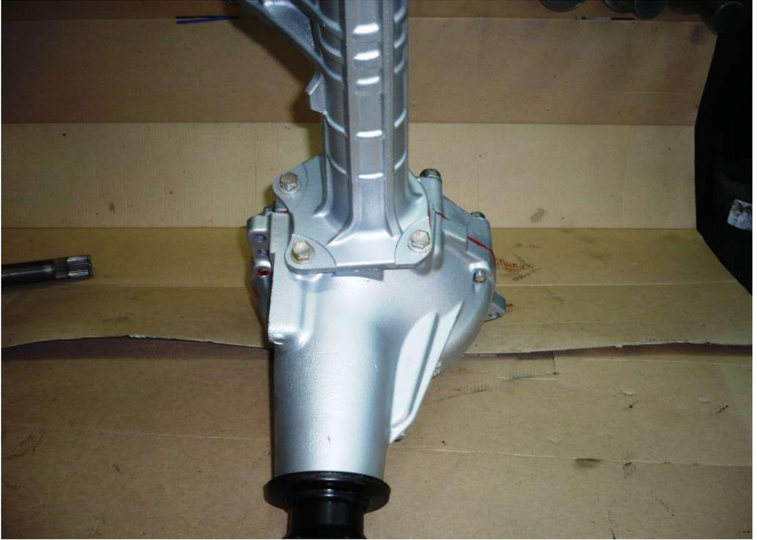
Следующая операция – установка вала
