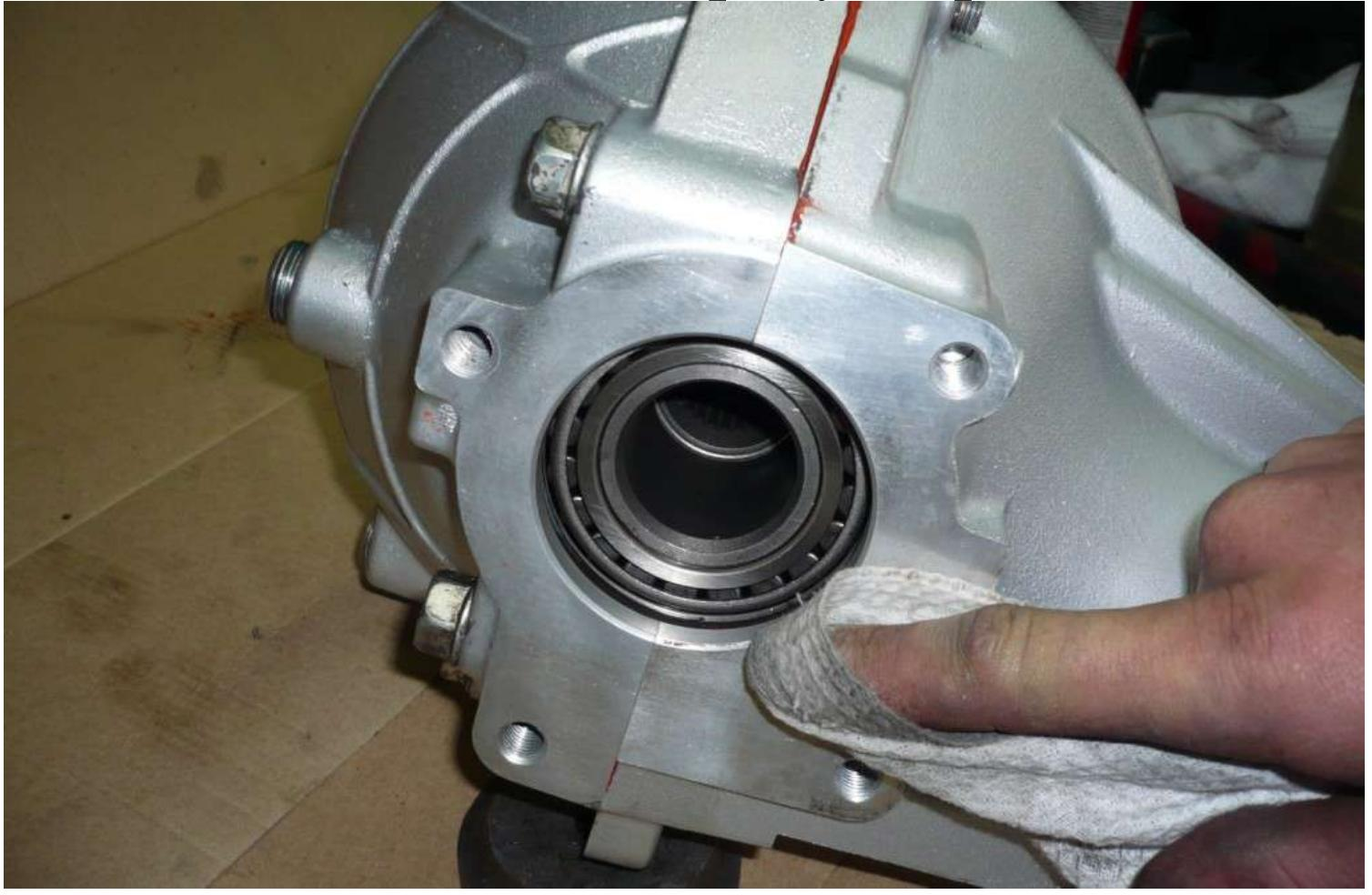
Наносим слой герметика
