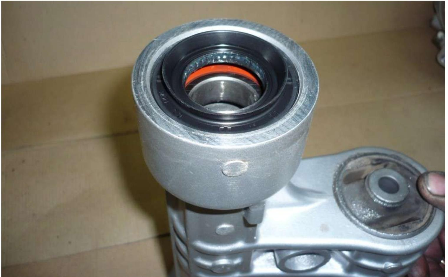
Далее обезжириваем прилегающую поверхность на трубе удлинителе
