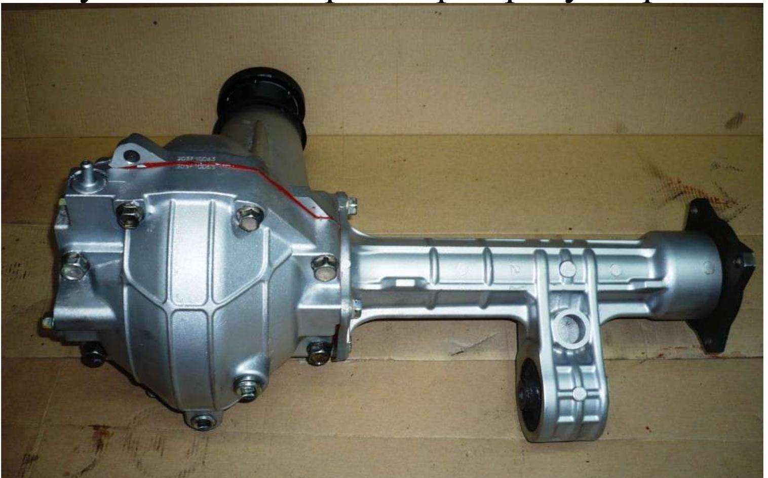
Обратите внимание, корпус каждого редуктора с завода имеет номерную маркировку. Она указана стрелками
