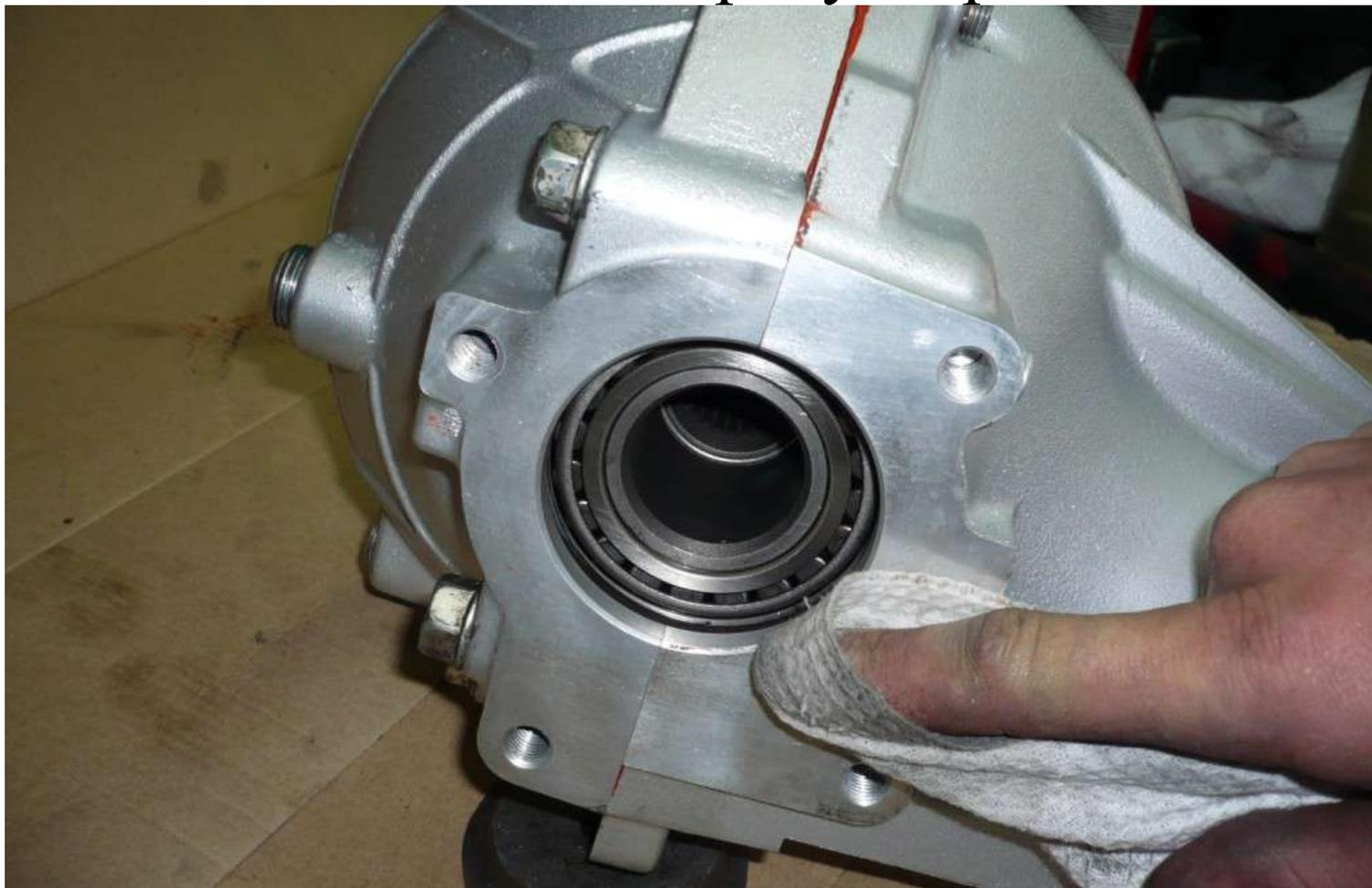
Наносим слой герметика
