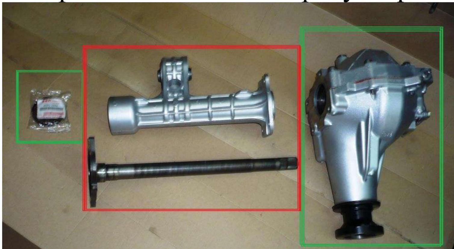
Для этого удаляем старый сальник с трубы - удлинителя левого привода, удаляем следы загрязнения. Опорный подшипник на данных редукторах **всегда** оказывается исправным, и замены не требует.
